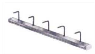
Ripresa di getto a staffa singola Lunghezza= 120 cm – Interasse ferri= 200 cm Larghezza cassetta: 55 cm. Diametro staffa: 8 e 10 mm.
