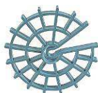
Distanziale O distanze cassero: 20 mm. per tondino Ø 4/8 25/30 mm. per tondino Ø 6/10
